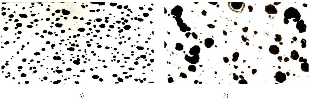
სურ. 2. ცელზიანის ელექტროკერამიკის ფორიანი ფაზის მორფოლოგიური სურათი. ა) 1450°C-ზე გამომწვარი, ბ) 1500°C-ზე გამომწვარი
