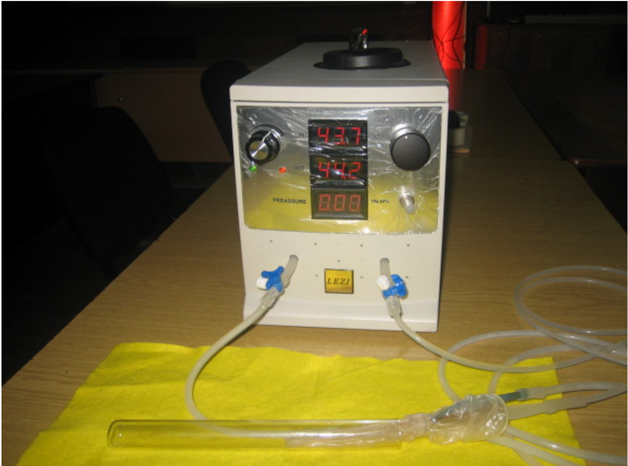
სურ. 1. მართვადი ლოკალური ჰიპერთერმიის მეთოდით სწორი ნაწლავისა და საშვილოსნოს ყელის სიმსივნური დაავადებების სამკურნალო აპარატი. დამზადებულია საქართველოს ტექნიკური უნივერსიტეტის ბიონანოკერამიკისა და ნანოკომპოზიტების მასალათმცოდნეობის ცენტრში (ხელმძღვანელი, პროფ. ზ. კოვზირიძე)
